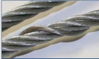
Lockerung der Außenlage
