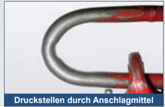
Druckstellen durch Anschlagmittel
