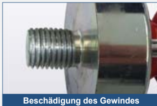
Beschädigung des Gewindes
