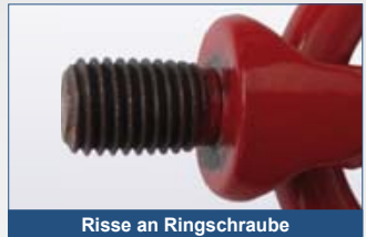
Risse an Ringschraube
