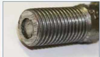
Seilanzug aus Gewindeteil
