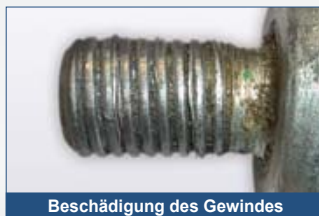
Beschädigung des Gewindes
