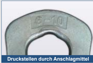
Druckstellen durch Anschlagmittel
