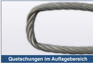
Quetschungen im Auflagebereich
