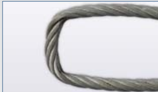
Quetschungen im Auflagebereich
