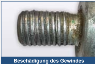
Beschädigung des Gewindes
