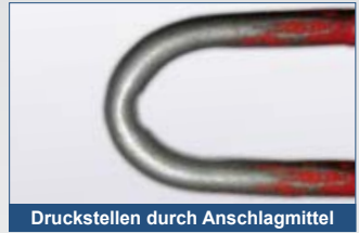
Druckstellen durch Anschlagmittel
